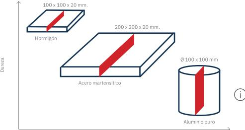
La capacidad de corte depende del tamaño de la pieza, pero también de la dureza y del área de corte de la misma.
